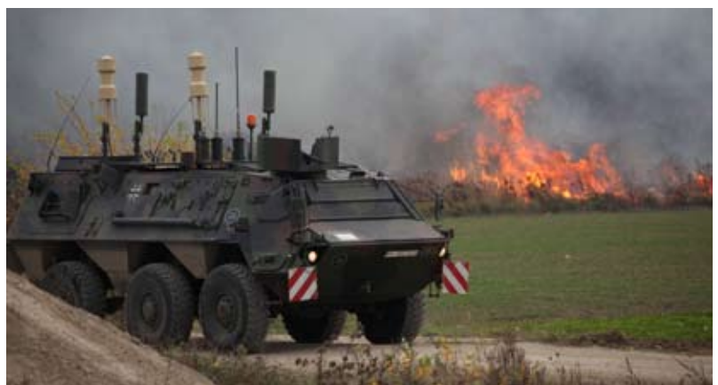
Bild unten: Der JAMMER der Deutschen Bundeswehr auf Transportpanzer Fuchs kann das verhindern.
