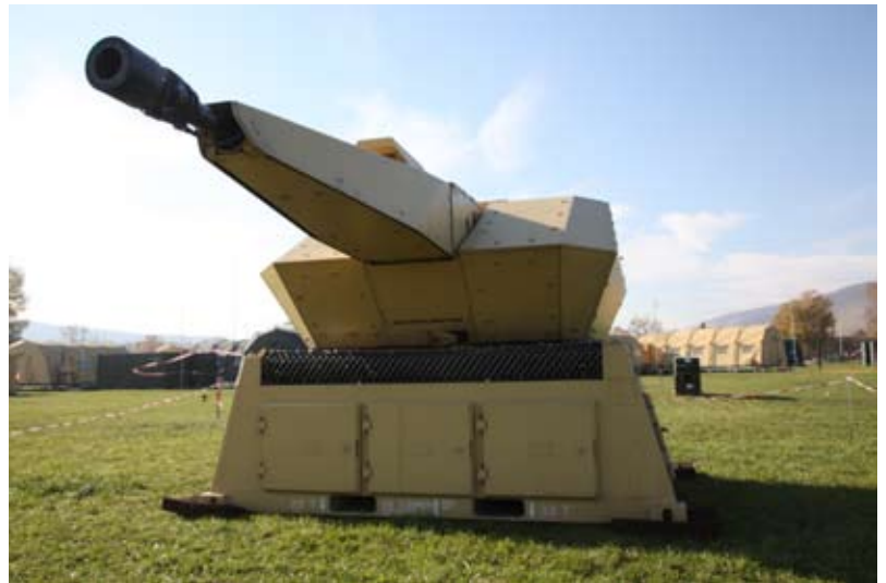
Bild oben: Zeigt das 35mm Geschütz des Systems MANTIS. Eine Revolverkanone mit einer Kadenz von 1.000 Schuss/Minute. Bild links: Kontingentführer und Staffelfelch der 1.FlaRakGrp 61, Hauptmann Benjamin Gerbrich. Bild unten: Sensoren des Systems überwachen wahlweise 12 oder 20 Kilometer Luftraum.
