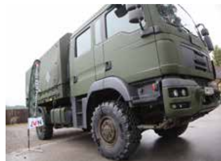
▲ Bilder oben zeigen die neuen MAN TGM 14.280 AD/DOKA/FS. Diese wurden speziell für die Fahrschule angeschafft, sind aber voll einsatztauglich. Ein sparsamer 280 PS-MAN-Diesel-Motor sorgt für den notwendigen Vortrieb.
