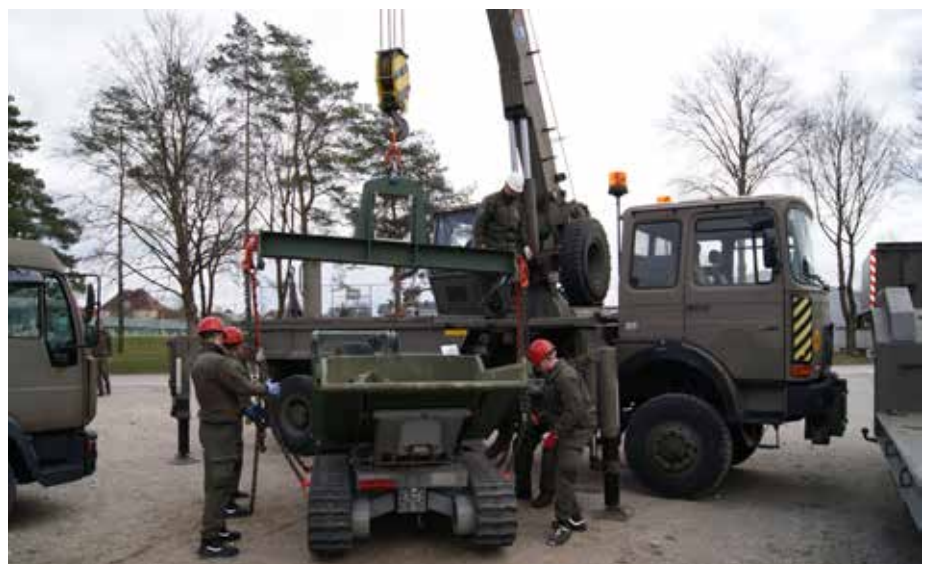
▼ Bild unten zeigt Ausbildungspersonal und Kursteilnehmer beim Beladen mit dem Palfinger-Autokran PK30. Dabei wird angenommen, dass ein Schadfahrzeug auf ein 30-Tonnen-Schwerlastsystem verladen wird.
