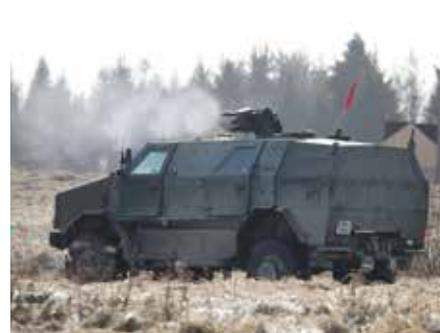
**Bilder oben** zeigen die geschützten Mehrzweckfahrzeuge beim Scharfschießen auf der Schießbahn Mannshalm. Am Bild links der Husar. Er verfügt nicht nur über eine Tagsichtoptik sondern auch ein Wärmebildgerät. Die Waffenstation nimmt ein 12,7 Millimeter Maschinengewehr auf, eine Nebelwurfanlage sorgt für den Eigenschutz, diese können zur Nahkampfverteidigung mit 40 Millimeter Sprenggranaten geladen werden.
