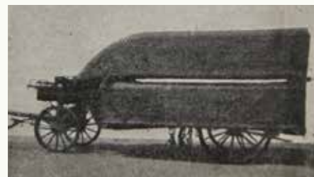
Bild: Der Pontonwagen Nr. 13 und 14 verbrachte Pontonstücke und die zur Verankerung notwendigen Geräte.
