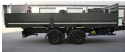
Bilder oben zeigen die mit Containertraverse, mechanischem Schubarm und Zubehör beladene Transportplattform. Der Anhänger ist zudem in der Lage Container zu transportieren.
