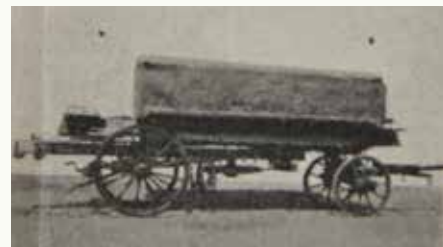
Bild: Zeigt den Bockwagen Nr. 9 bis 12 . Er verbrachte jeweils zwei-geteilte Unterstützungen und wurde wie die beiden anderen Wagen von der Traintruppe bespannt.
