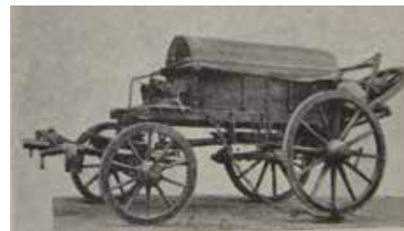
Bild: Der Kleingewehrmunitionswagen alter Art war vier-spännig und wurde in den Reservemunitionskolonnen verwendet. Er verbrachte 18 Verschläge mit jeweils 1.350 Patronen für Gewehre.
