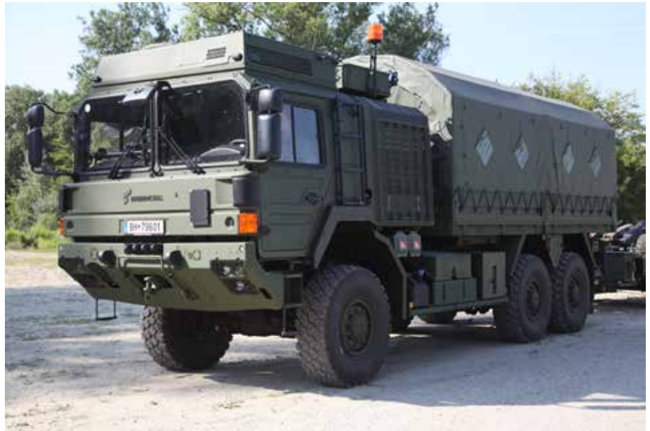
Bilder: Zeigen das leichte Bergesystem von MAN und Rheinmetall. Das Fahrzeug ist mit zwei 12 Tonnen-Winden, einem Ladekran zum Bergen und mit einem teleskopierbaren Abschlepparm bestückt.
