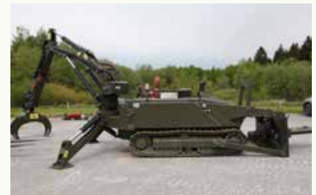
Bilder oben: Zeigen das kleinere Minenräumsystem MV-4. Der Bediener kann in kurzer Zeit einen Roboterarm, eine Greif- und Schneidzange, ein Räumschild, Staplerzinken oder den sich drehenden Vorspann anbauen.
