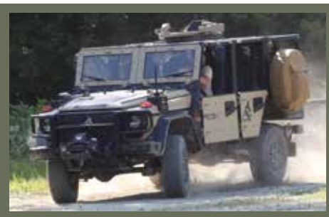
Bild rechts: Zeigt das luftgestützte Fahrzeug der Firma ACS - Armoured Car Systems GmbH. Das luftlandefähige Fahrzeug wurde auf Basis eines Mercedes G konstruiert und ist durch die Mehrzweckplattform vielseitig und individuell baubar.
