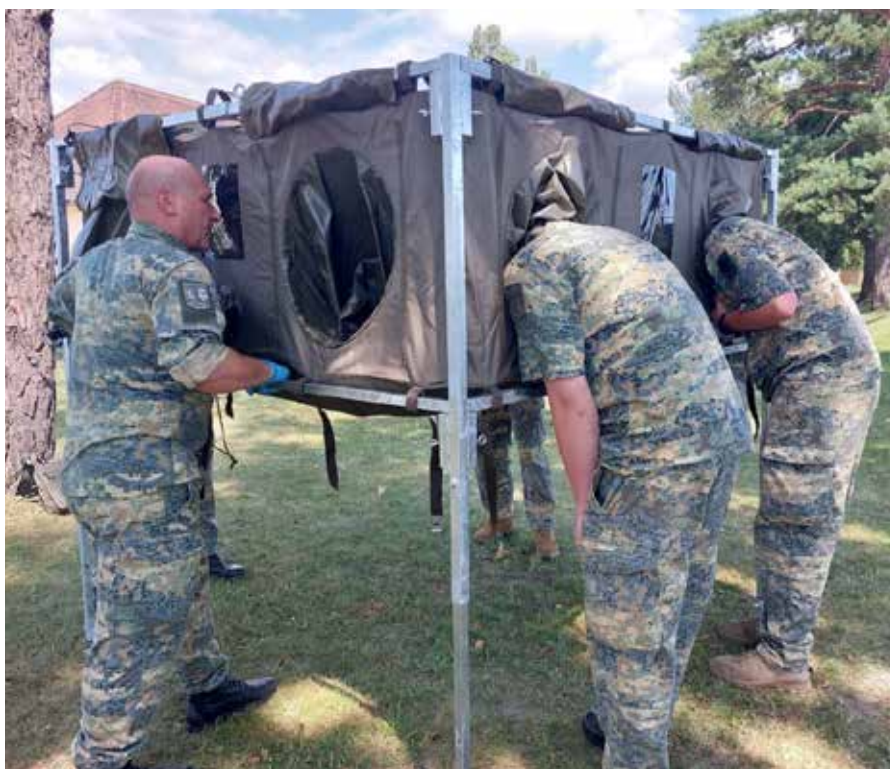
Bild oben: Zeigt die ersten Gehversuche mit der mobilen C-Prüfkammer. Die auf- und abzubauenende Anlage dient der Dichtheitsprüfung der neuen Schutzmaske. Die Prüfkammer erfüllt ihren Zweck und erspart oft mühsame Verlegungen.
