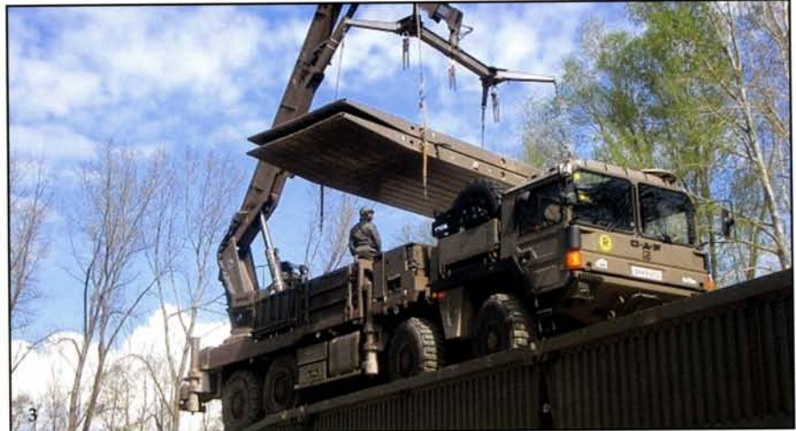
Die ungarischen und deutschen Gäste am Antreppplatz vor dem Kommandogebäude (1). Ungarischer Brigadegeneral KOVÁCS und Hptm SCHULMEISTER auf der fertigen Brücke beim Austausch von Gastgeschenken (2). Das Verlegefahrzeug beim Einbringen der jenseitigen Rampe (3).
