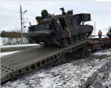
Die Verladung der ZLR für den Transport zum Einsatzort erfolgte wie im Falle der Pionierkampfunterstützungskompanie auf einem zusätzlichen Eisenbahnwaggon. Der Auf- und Abbau wird durch ein Rampenkommando durchgeführt (Bilder links).
