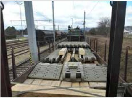
**Mit an Bord: Die zerlegbare Laderampe 60 (ZLR 60).** Diese stammt aus den Beständen der Nationalen Volksarmee (NVA) der DDR und ist beim Eisenbahntransport für das Ver- und Entladen von Gefechtsfahrzeugen auf freier Strecke, Bahnhöfen und Anschlussgleisen nutzbar. Sie wird eingesetzt, wenn keine ortsfesten Ver- und Entlademöglichkeiten vorhanden sind. Grundsätzlich wird die Laderampe als Stirnrampe aufgebaut.
