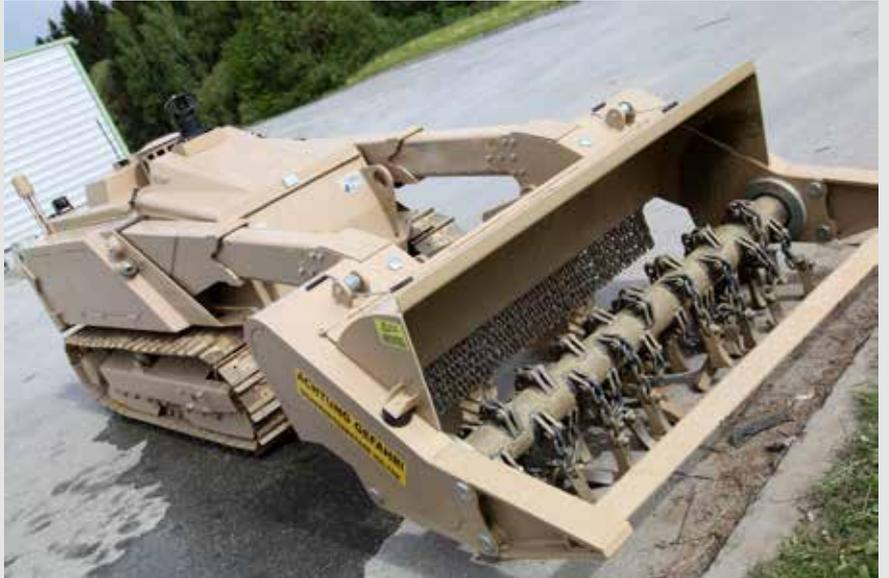
**Bild oben:** Zeigt das von der kroatischen Firma DOKING entwickelte und gebaute, fernsteuerbare Räumgerät auf Kettenbasis MV4. Das Spezialgerät zählt zu den kleinen Räumgeräten und eignet sich besonders bei Zufahrten, schmalen Straßen und Wegen.
