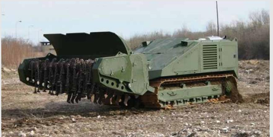
**Bild unten:** Der 10 Meter lange und 2,68 Meter hohe Minenräumer HYDREMA 910 MCV-2. Während der Schlegelbewegung dreht sich die Welle bis zu 440 mal pro Minute, so dass die Hämmer in den Boden eindringen und die Minen so zur Detonation bringen und zerstören.
