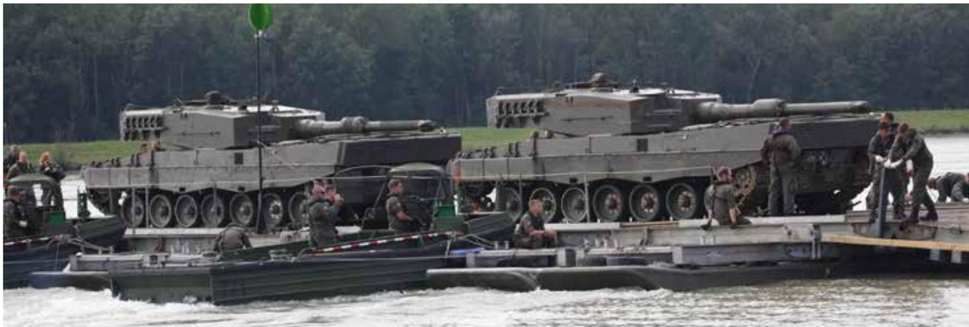
**Bild oben** zeigt die Fähre beladen mit zwei Kampfpanzern Leopard 2A4 (je 55 Tonnen), das **Bild rechts** zeigt die Fähre beladen mit einem 84 Tonnen schweren 400 Metertonnenkran der Firma Felbermayr.
