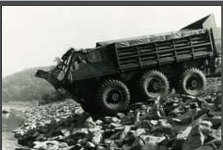
**Bild oben:** Alvis-Stalwart aus den 60er Jahren mit achtzylinder Rolls Royce Otomotor. Insgesamt wurden nur 1100 dieser schwimmfähigen und robusten Nachschubfahrzeuge gebaut. Nur wenige davon fanden bei den Melker Pionieren Verwendung.
