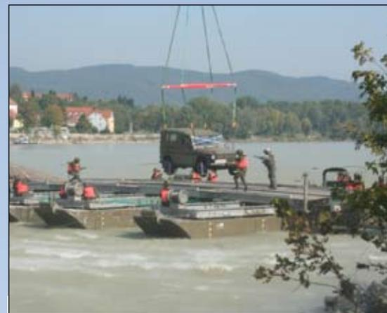
**Bild oben:** 25, 50 oder 75 Tonnen Fähren können im Anlassfall gebaut werden.
