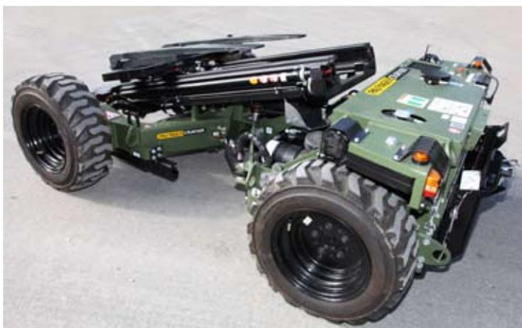
**Bilder:** Zeigen das klappbare Feldladergerät (FLG140) des Kampfmittelabwehrzuges der Technischen Kompanie. Das allradgetriebene Fahrzeug ermöglicht durch Fernbedienung ein gefahrloses Arbeiten aus sicherer und geschützter Entfernung.
