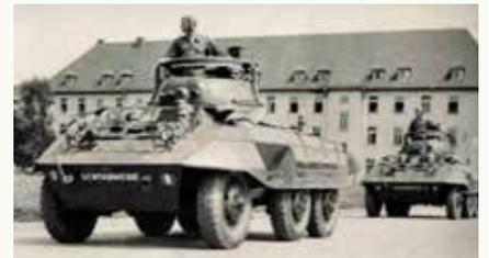
Das vorne an der Wanne bis zu 20mm gepanzerte Fahrzeug hatte im Heck einen Hercules Sechszylinder-Reihenmotor mit 5,2 Liter Hubraum und 110 PS eingebaut. Die Höchstgeschwindigkeit des 7,5 Tonnen schweren Radpanzers betrug bis zu 90 km/h.
