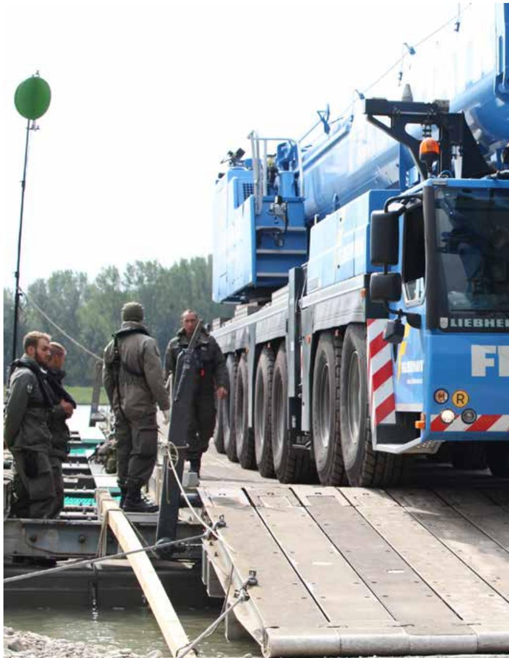
**Bild oben:** Zeigt die Millimeterarbeit beim Verladen des 84 Tonnen schweren Kranes der Firma Felbermayr. Der Fährkommandant bewährte sich gemeinsam mit dem professionellem Fahrer und dem Einweiser derart, dass die verstellbare Luftfederung der sieben Achsen so gut justiert war bzw. laufend angepasst wurde, sodass ein Auffahren des langen Kranfahrzeuges trotz der gegenläufigen Neigung von Rampe und Landestelle gewährleistet wurde.
