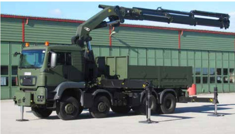
**Bild links:** Allradgetriebener MAN mit Palfinger Ladekran PK 76.002 und ausziehbarem Aufbau. Dadurch optimiert sich der Verwendungszweck auf beispielsweise den Transport von 20-Fuß-Containern.
