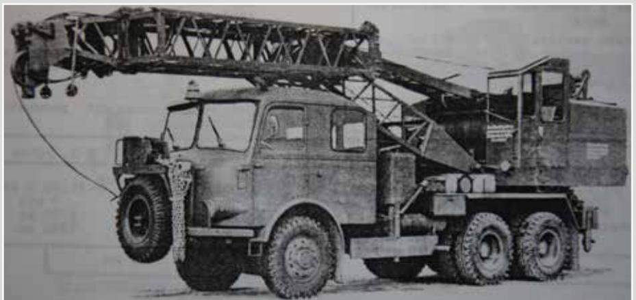
**Bild oben:** Der links beschriebene Krankraftwagen von Gräf & Stift (Wien). Er brachte bei einer Länge von 11,5 Meter stolze 24.750 Kilogramm Eigengewicht auf die Waage. Die Höhe betrug durch den umgelegten Kranausleger 3,6 Meter. Somit war im Straßenverkehr eine Transportweggenehmigung erforderlich (Quelle ÖBH, Vzlt i.R. Karl Enzinger).
