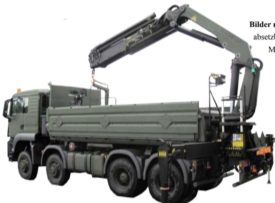
**Bilder unten:** Zeigen die neuen EMPL Kipperaufbauten mit absetzbarem Palfinger-Heckkran auf dem allradgetriebenen MAN TGS 8x8 MIL. Der Heckkran ist zudem an allen anderen MAN-Kipperfahrzeugen gleicher Bauart ohne zusätzliche Adaptierungsarbeiten aufbaubar. Bilder zeigen den Palfinger PK 26002-EH D Power Link plus.
