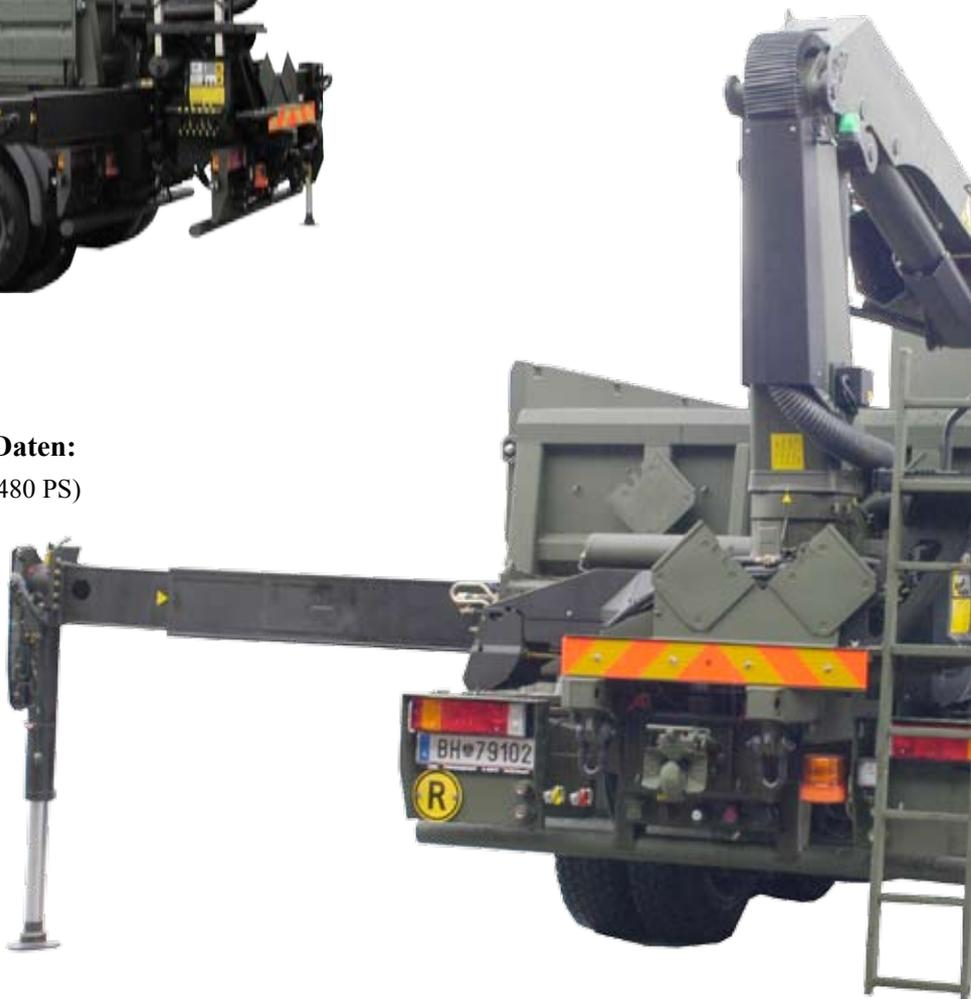
**Bild rechts:** Zeigt den neuen MAN TGS 41.480 8x8 mit EMPL Kipperaufbau und Palfinger PK 26002-EH D Power Link plus Frontkran. Der am Bild gezeigte Ladekran hat bei einer Abstützbreite von links und rechts 2,5 m und einem Hauptarmwinkel von 20 Grad dasselbe Lastmoment wie der links gezeigte Heckkran (Ausladung 4,20 m Tragfähigkeit bis zu 5.200 kg). Die maximale Arbeitshöhe erreicht 18 m.
