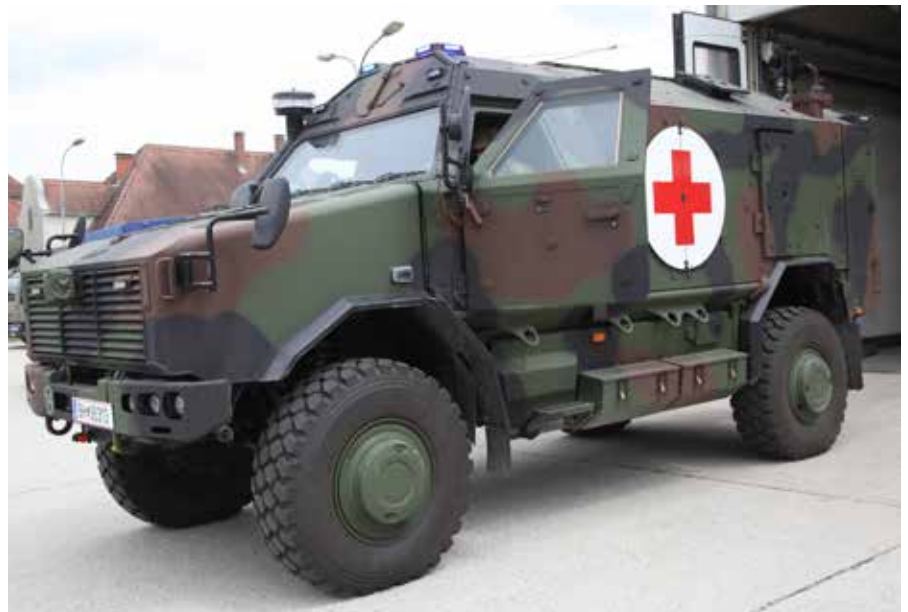
Bild oben: Zeigt Das Notfallfahrzeug „ATF NF (DINGO 2 Emergency Vehicle)“ Es kann auch mit einer Versorgungskammer für kontaminierte Personen ausgerüstet werden.
